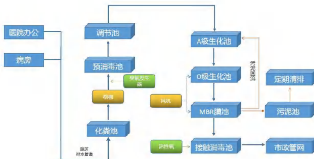
图6 实际建设污水处理工艺流程图
